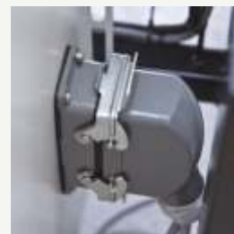
Быстроразъемное крепление позволяет легко отделить конвейер
