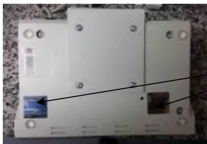
Схема пломбирования контрольными этикетками
